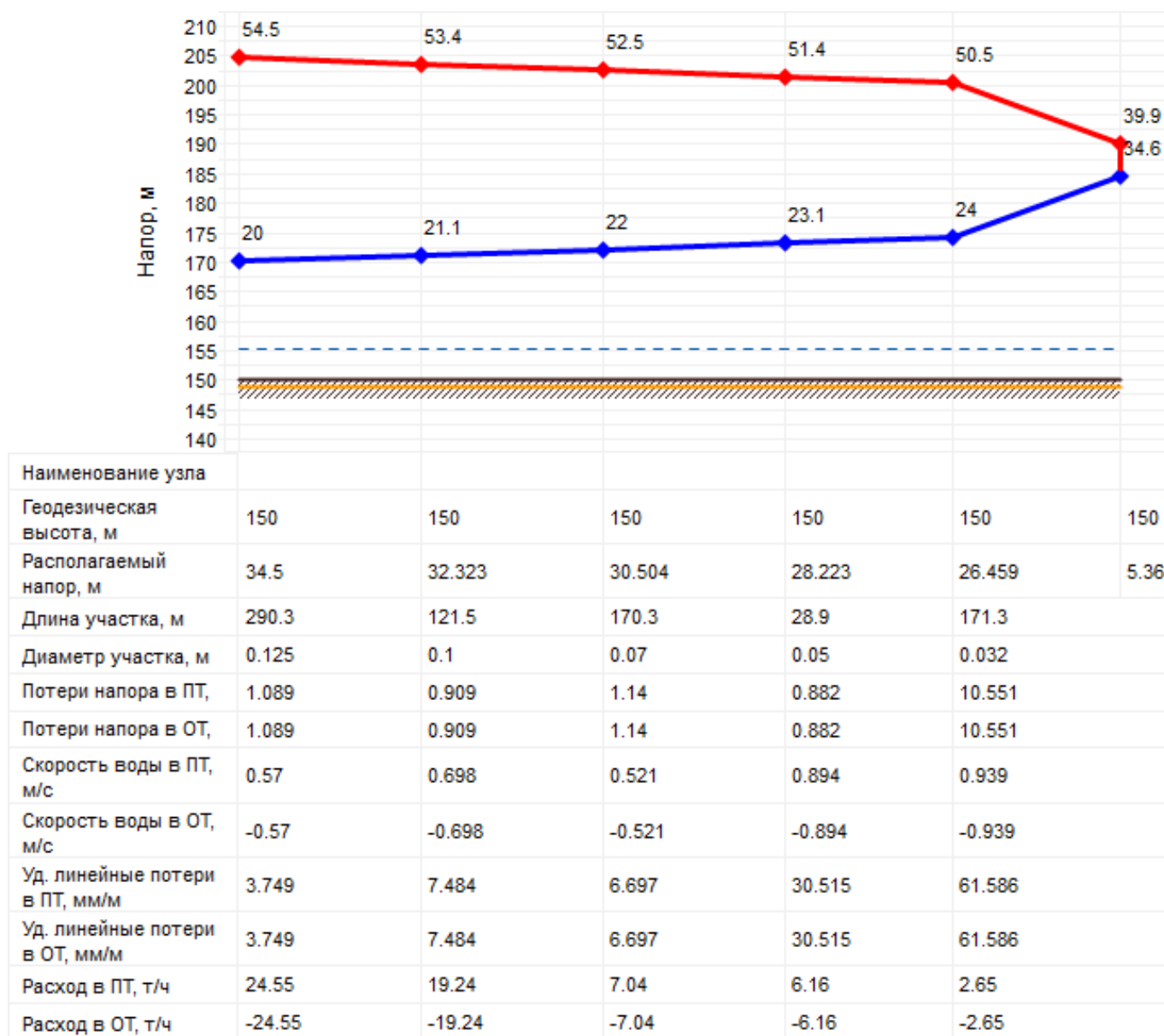
Рисунок 2.5 – Пьезометрический график тепловой сети по магистральному выводу котельной № 22 с. Алексеевка
