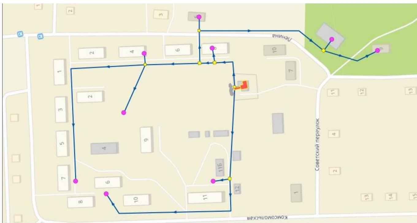
Рисунок 2.7 – Модель системы теплоснабжения котельной № 5 с. Звездино
